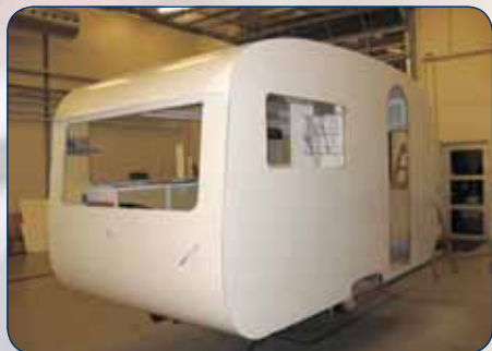
Så er tiden kommet til at sætte alu lister på vognen. Den gamle originale bagrude er nu også monteret. Taget er malet, så det også ser nyt ud.
