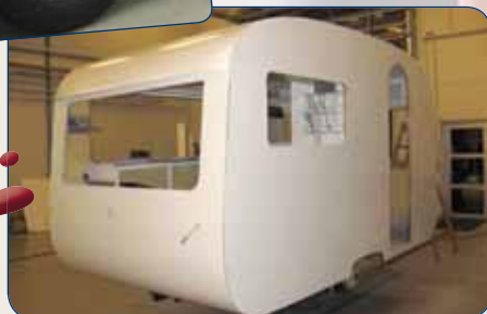
Her ses den færdige side samt bagende efter de nye plader er færdig monteret.
