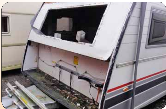
(2) Fronten afmonteret på den brændte Cabby 650+.
