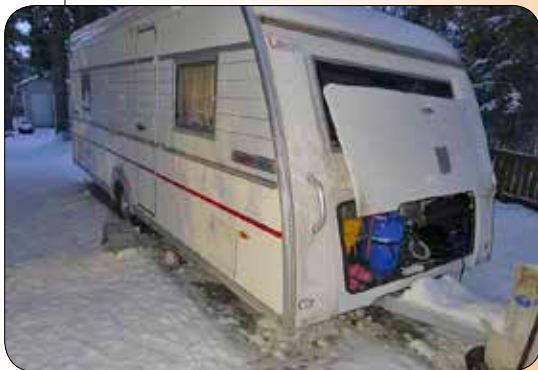
(4) Frontskaden på Cabby 620+Fronten på 620+ efter montering af front fra Cabby 650+.
